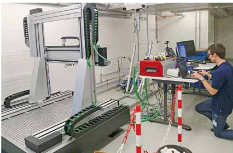
Die Genauigkeit des Scanners ergibt sich aus der Differenz zwischen den gemessenen Ist-Werten und den definierten Soll-Werten. Hier Benjamin Wyrsh von Varian Medical Systems bei der Auswertung.
